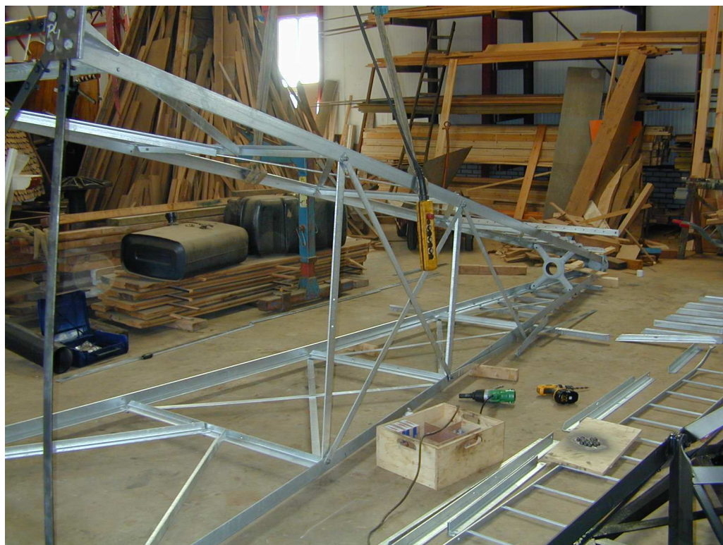
Toren in liggende toestand, volledig thermisch verzinken welke in zijn geheel zwart gecoat wordt.
